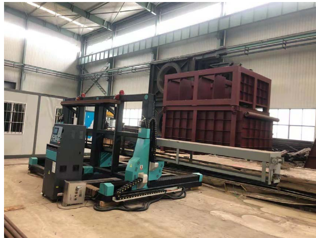
废酸裂解装置火管锅炉(含灰) 自动清灰装置
