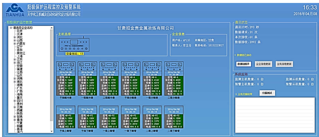
图 3 基于物联网技术的阳极保护远程监控系统
