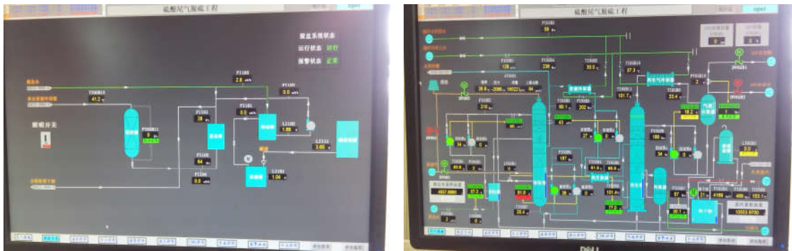
图 3 制酸尾气吸收工艺控制中控画面图
